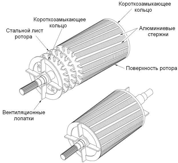
Рис. 13.6. Короткозамкнутый ротор асинхронного электродвигателя
