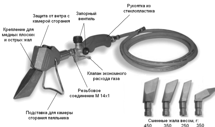
Рис. 17.68. Газовый паяльник фирмы Rothenberger имеет медное жало, согнутое под углом 45°, жало может поворачиваться на 360°
