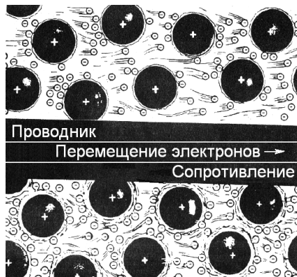
Рис. 3.14. Перемещение свободных электронов под действием электрического поля
