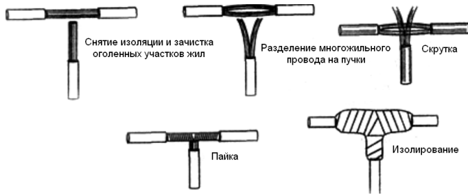
Рис. 17.65. Ответвление от провода с многопроволочной жилой
