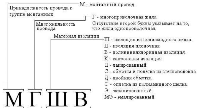
Рис. 17.36. Буквенное обозначение установочных проводов с оболочкой
