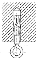
Рис. 17.91. Анкер-крюк НА 8 и его установка
