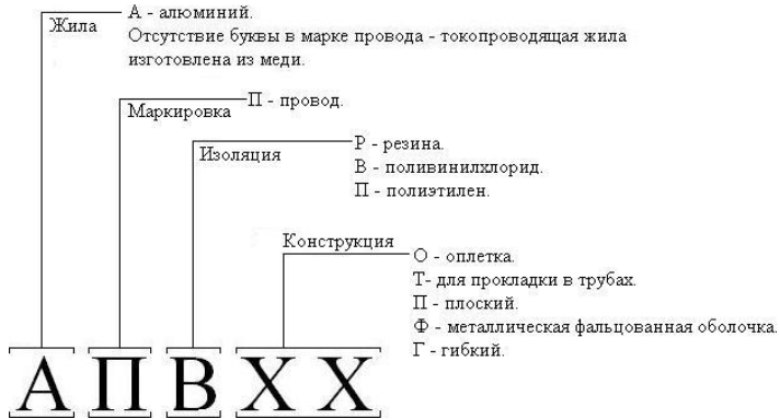
Рис. 17.36. Буквенное обозначение установочных проводов с оболочкой
