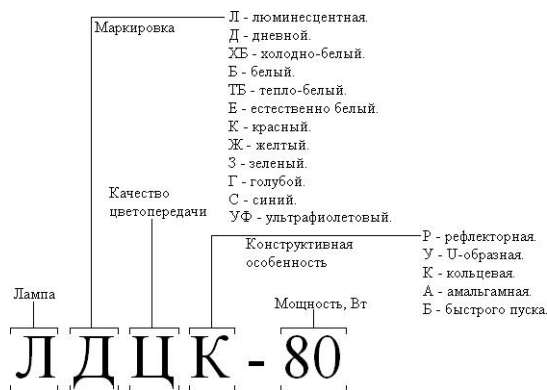
Рис. 5.4. Маркировка отечественных люминесцентных ламп
