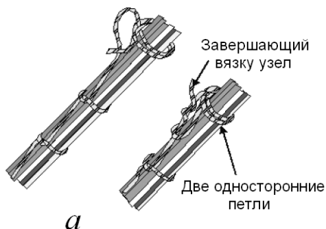
Рис. 17.153. Альтернативный метод завершения вязки потока проводов
